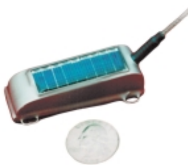
Figure 2. Émetteur solaire aérodynamique de 20 grammes. Figure 2. A 20 gram solar PTT designed like a racecar.
