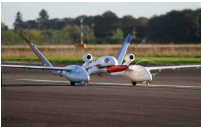
EOLE : Système aéroporté de lancement pour petits satellites étudié dans le cadre du projet PERSEUS
