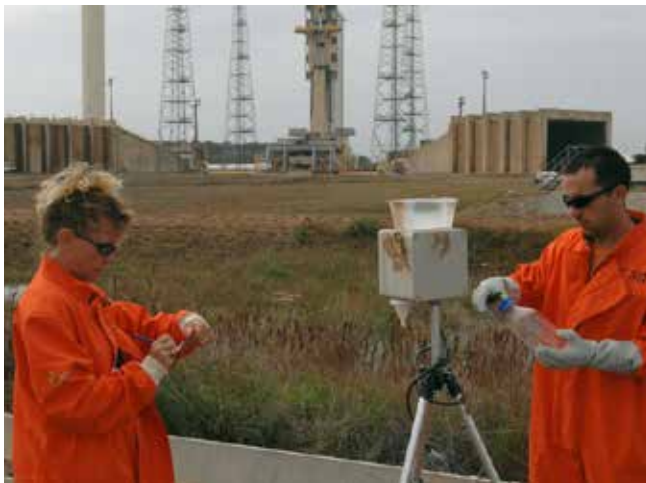
Relevé d'un bac à eau après un lancement. 45 bacs à eau de ce type sont utilisés pour mesurer notamment le taux de chlore dans l'air.
