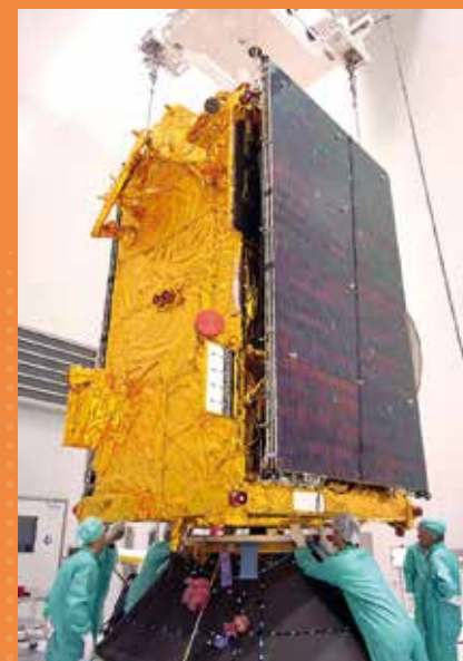
Pose du satellite Syracuse 3B sur l'Adaptateur de Charge Utile (ACU) du lanceur Ariane 5.
