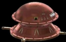
L'ATV-2 se désintégrera en raison de l'échauffement aérodynamique, et sous l'effet des secousses, le dispositif REBR - un « téléphone portable doté d'un bouclier thermique » se détachera du *Johannes Kepler*. Le REBR activera alors son propre transmetteur et transférera les données enregistrées vers un satellite Iridium. Avec ce dernier « appel » avant l'impact dans l'océan Pacifique, la future boîte noire de l'espace pourrait bien voir le jour.
