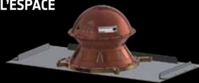
Au moment où l'ATV-2 entrera dans l'atmosphère, le système activera ses capteurs afin d'enregistrer pendant environ cinq minutes des données sur la désintégration du véhicule.
