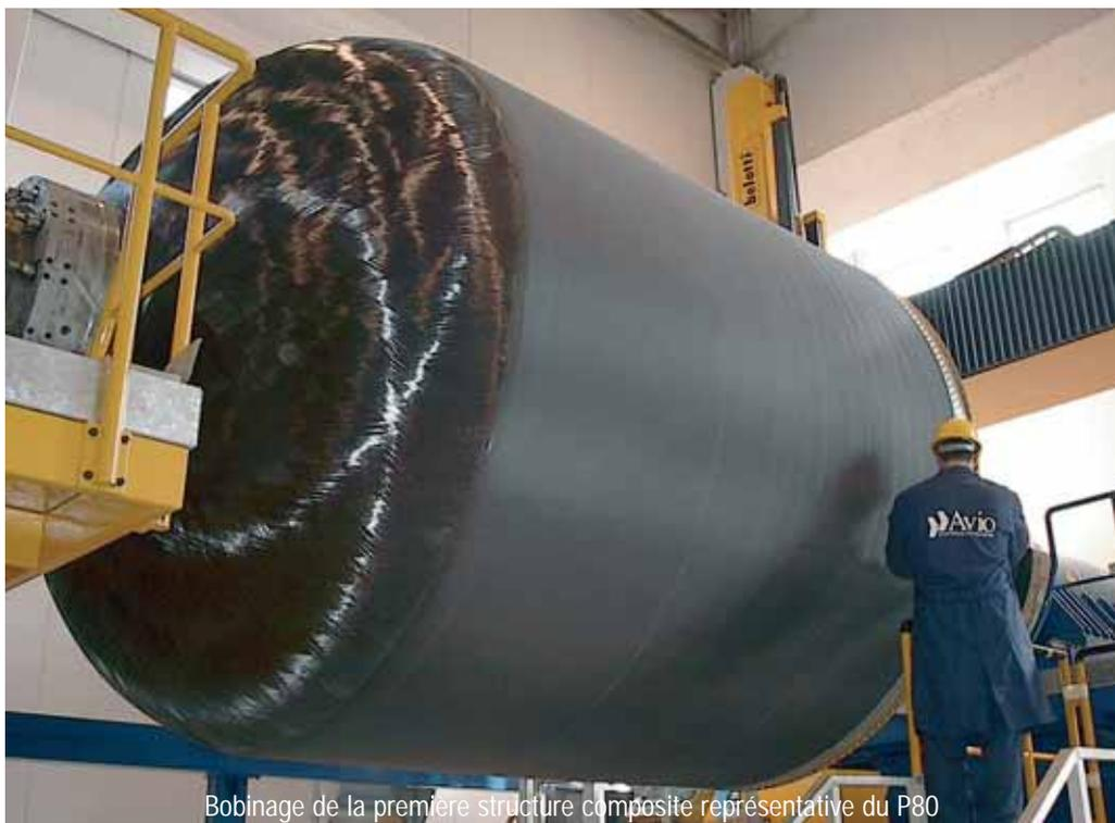
Bobinage de la première structure composite représentative du P80
