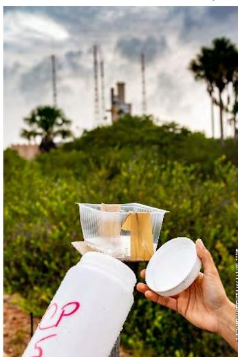
Figure 3 : Dépose d'un bac à eau avec son flacon d'échantillonnage
