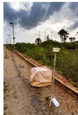
Figure 2 : Bac à eau sur son trépied métallique et SPM Honeywell sur le chemin de ronde AR5
