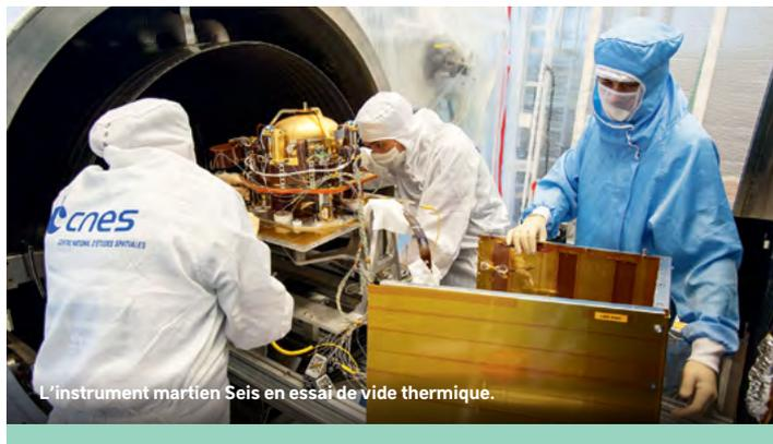
L'instrument martien Seis en essai de vide thermique.
