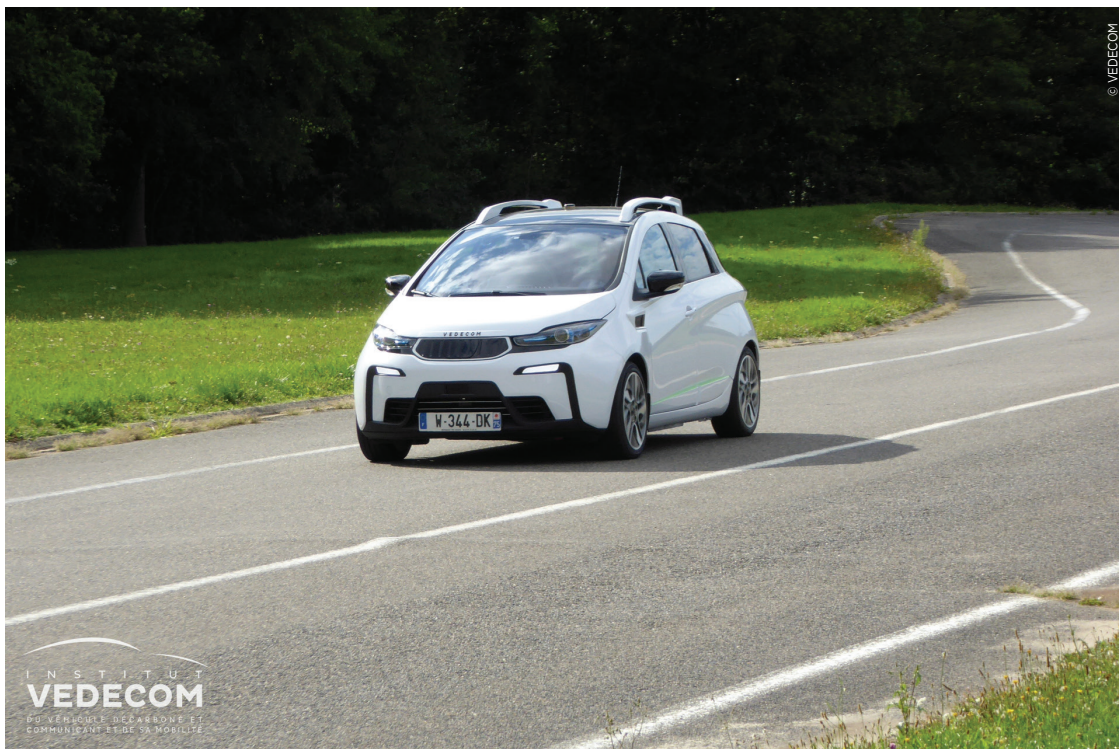
Démonstrateur à conduite déléguée de l'institut de recherche VEDECOM, développé à partir d'une ZOE électrique.
