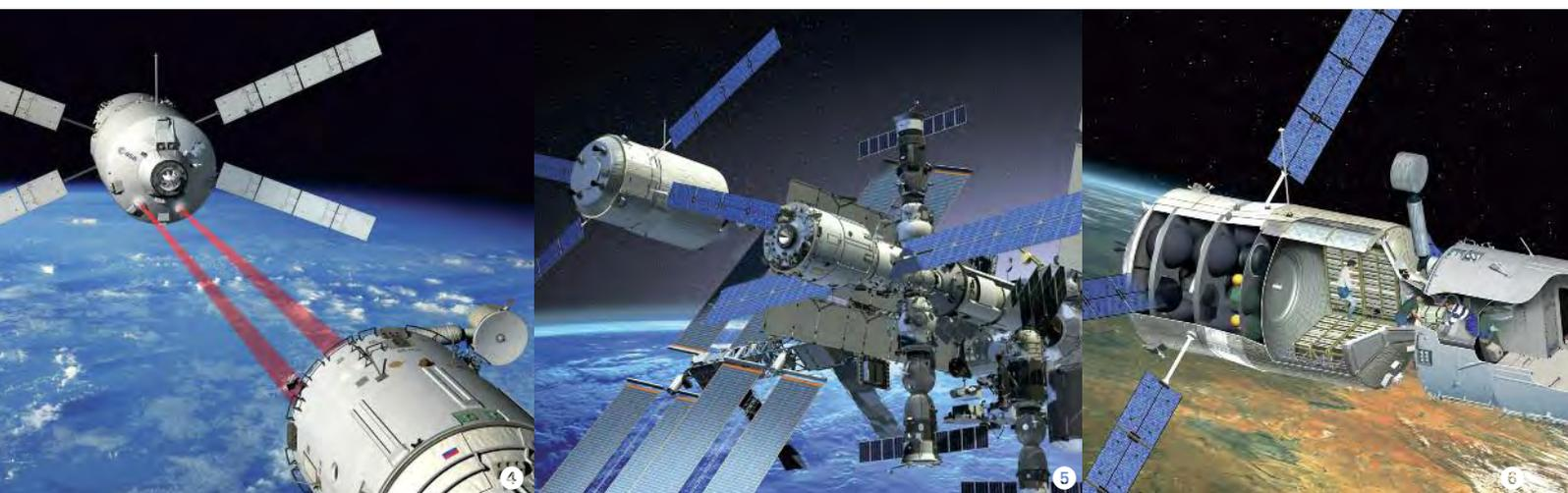
4 Pour le rendez-vous automatisé, les derniers kilomètres sont sous surveillance permanente de l'ATV-CC. 5 L'amarrage est réalisé avec une précision centimétrique, alors que le cargo et la station se déplacent à 28 000 km/h. 6 Une fois amarré (relié aux plans mécanique, informatique, électrique et hydraulique), le cargo devient un module à part entière de la station.
