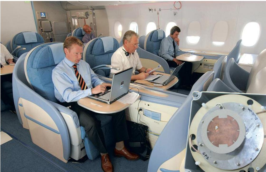
Utilisée dans la cabine d'un avion en vol, l'antenne permettra aux passagers de connecter un équipement portable personnel (Smartphone, tablette et ordinateur portable) à Internet, via une liaison satellite (Satcom). Used in flight in an aircraft cabin, this antenna will let passengers connect mobile personal devices (smartphones, tablets or laptops) to the Internet via satellite.
