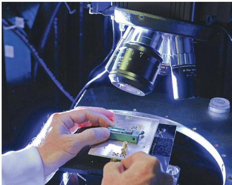
▲▲ Composant endommagé, ausculté sous un microscope à balayage laser au CNES Toulouse.
