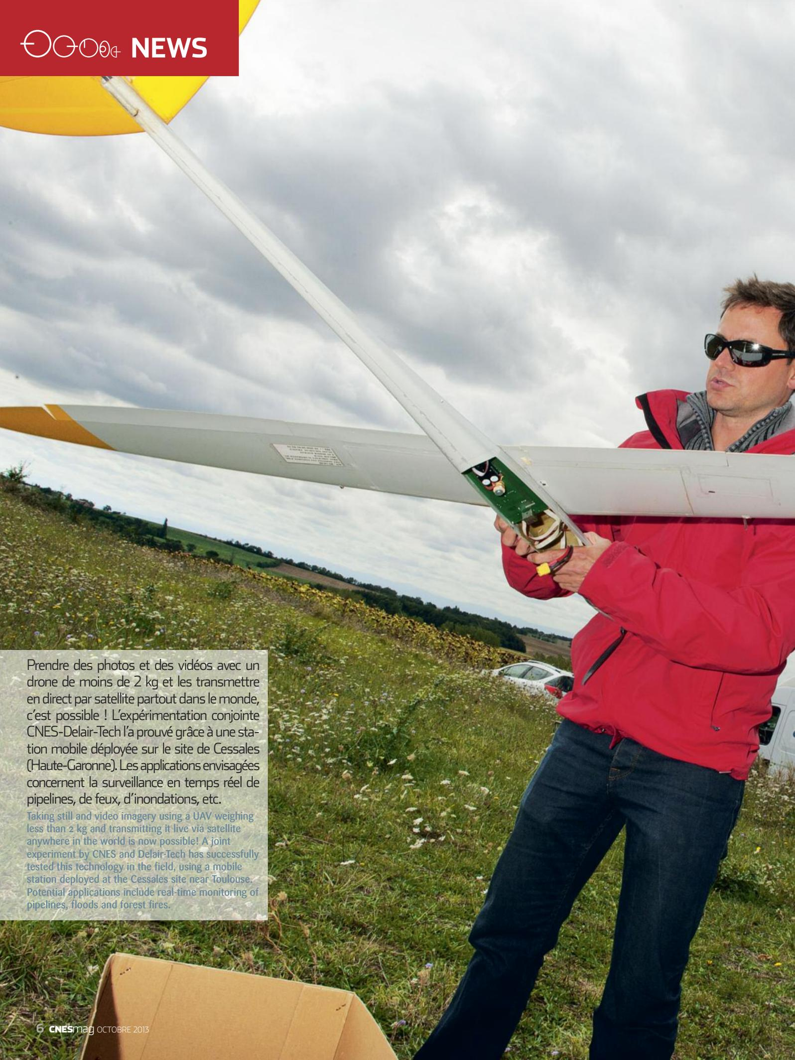
Prendre des photos et des vidéos avec un drone de moins de 2 kg et les transmettre en direct par satellite partout dans le monde, c'est possible ! L'expérimentation conjointe CNES-Delair-Tech l'a prouvé grâce à une station mobile déployée sur le site de Cessales (Haute-Garonne). Les applications envisagées concernent la surveillance en temps réel de pipelines, de feux, d'inondations, etc.
