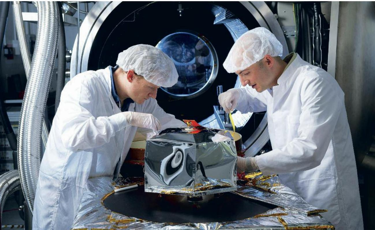
◀◀ Préparation aux essais thermiques du sismomètre SEIS dans le caisson de 3 m<sup>3</sup>, au CNES Toulouse. The SEIS seismometer is prepped for thermal testing in the 3-m<sup>3</sup> chamber at CNES in Toulouse.
