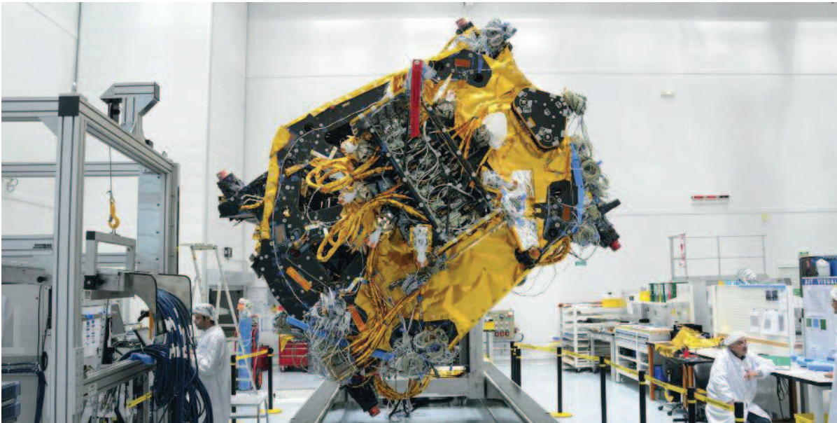
◀◀ Préparation du satellite Athéna-Fidus pour des essais de vide thermique chez Thales Alenia Space, à Cannes. The Athena-Fidus satellite is prepped for thermal vacuum testing at Thales Alenia Space, Cannes.
