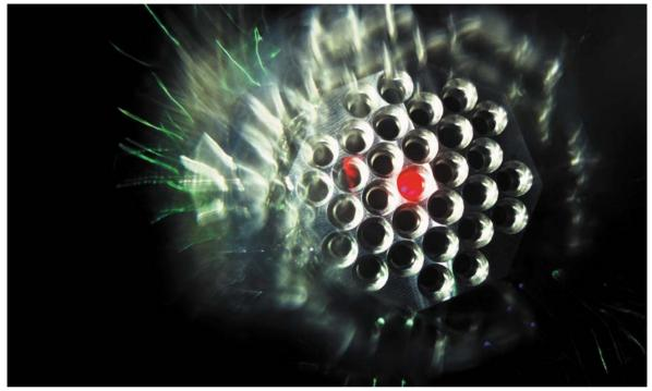
Antenne multifaisceaux de satellites de télécommunications.
