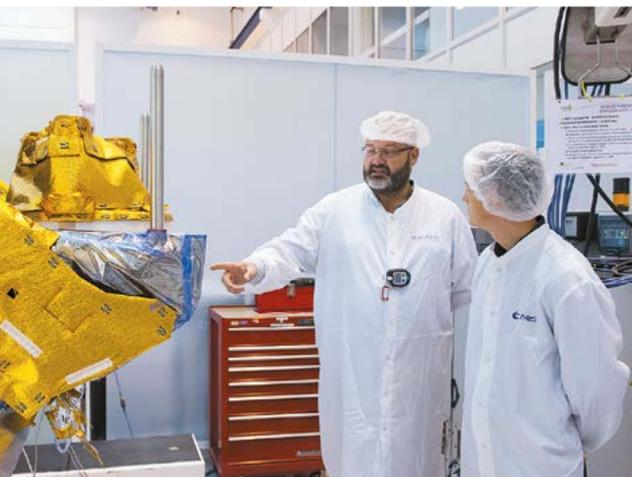
Intégration du modèle électrique de l'instrument Swim par les ingénieurs du CNES.
