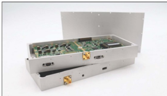
Argos-Néo, modèle miniaturisé de l'instrument Argos-4.
