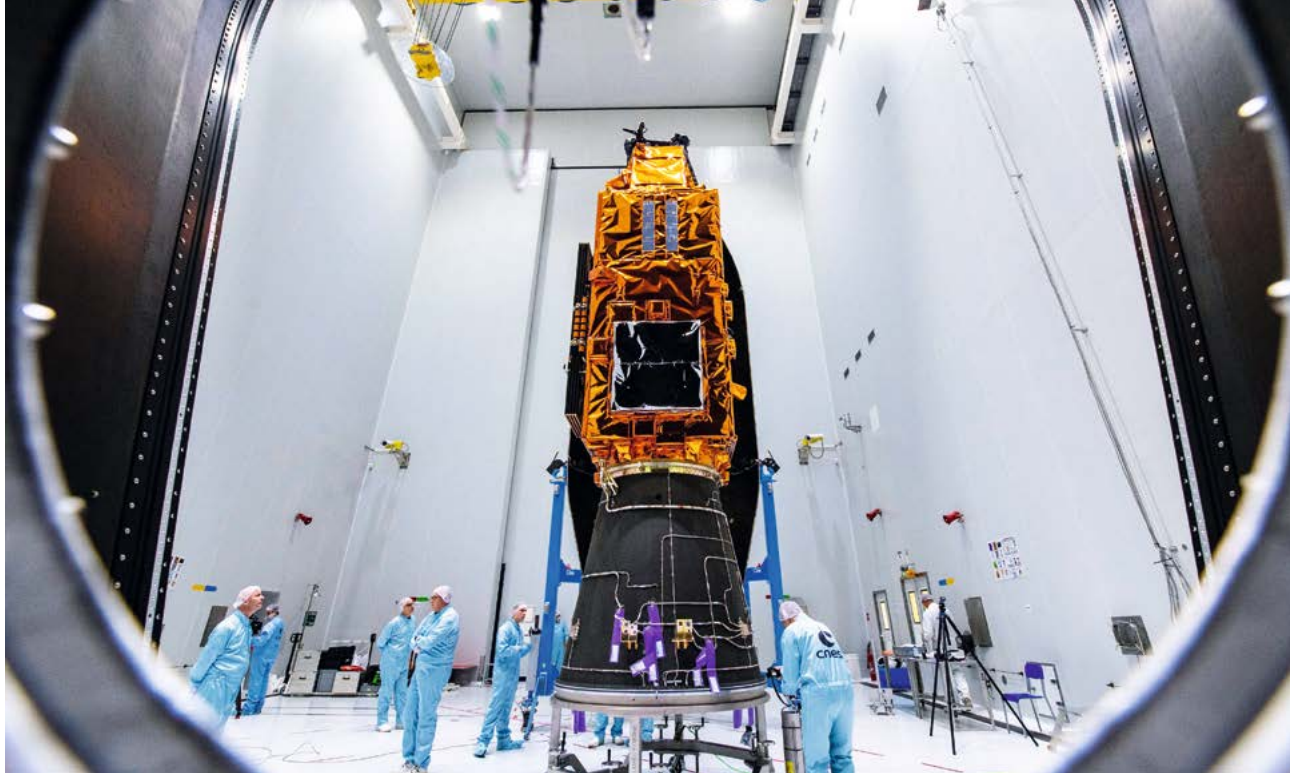
Le satellite Biomass dans la coiffe du lanceur Vega en vue de son lancement depuis le Centre spatial guyanais.
