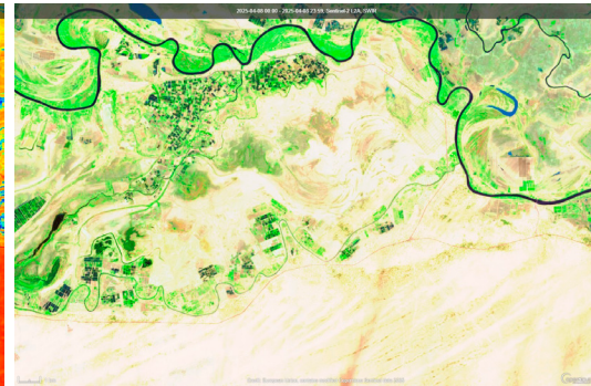
Image satellite Sentinel-2 A avec traitement infrarouge à ondes courtes (SWIR) qui permet d'estimer la quantité d'eau présente dans les plantes et le sol (les longueurs d'onde SWIR sont absorbées par l'eau). Présence d'eau en vert.
