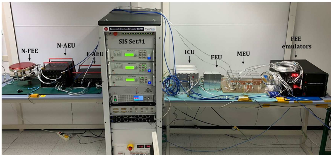
Légende : Ensemble du DPS en cours de tests (modèles EM). © Plato Consortium.
