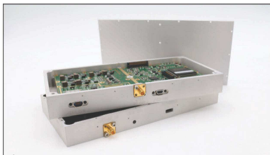
Argos-Néo, modèle miniaturisé de l'instrument Argos-4.
