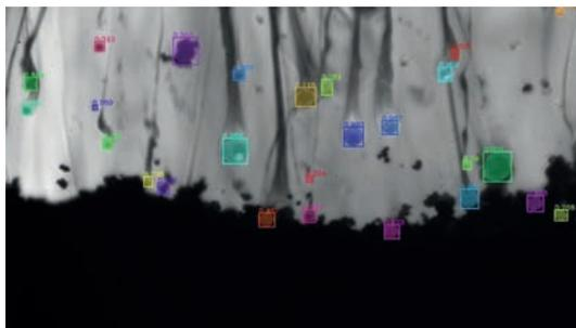
Détection des gouttes d'aluminium lors d'un essai par ombroscopie à l'ONERA.
