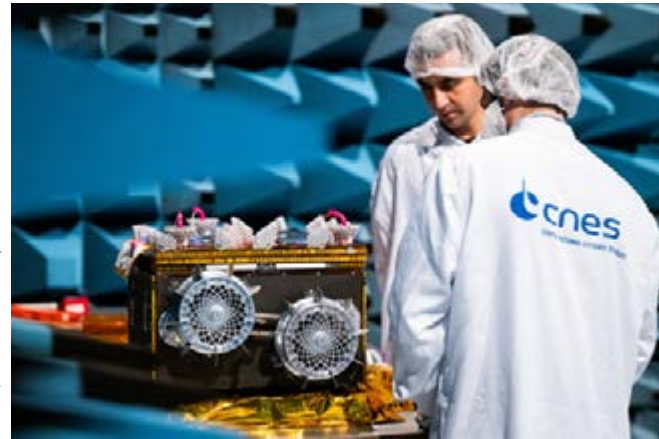
Essais EMC du Rover MMX © CNES/LANCELOT Frédéric, 2023
