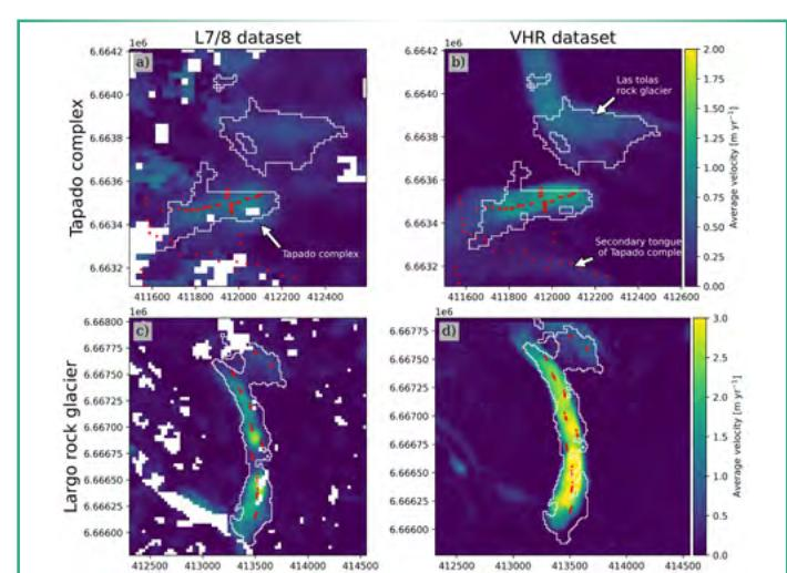
**LÉGENDE :** Comparaison des vitesses annuelles moyennes sur 2000–2020 pour le complexe de Tapado (a-b) et le glacier rocheux de Largo (c-d), à partir des jeux de données Landsat-7/8 et très haute résolution (Pléiades), respectivement. Les points rouges indiquent l'emplacement des stations GNSS (CEAZA, 2023). Les polygones blancs délimitent les PMA identifiées à partir des données L7/8 (Adapté de Cusicanqui et al., 2025.).
