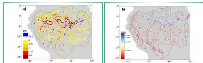
**LÉGENDE :** Caractéristiques de la sécheresse dans l'Amazone en 2023 vues par altimétrie spatiale. (a) Anomalie du minimum des hauteurs d'eau des rivières en 2023 comparées au long-terme pour chaque station virtuelle ; (b) Propagation de la sécheresse vue par SWOT en estimant la différence de temps entre le niveau d'eau minimum de 2023 enregistrée chaque 200m par SWOT et celui mesuré à la station de mesure Obidos, proche de l'exutoire du bassin.
