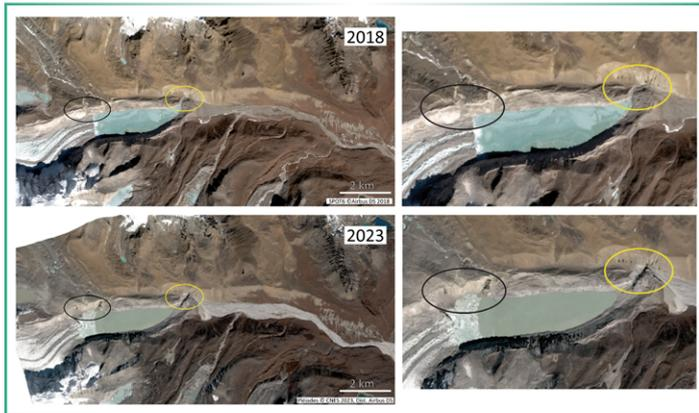
**LÉGENDE :** Les images des satellites SPOT6 (Airbus) et Pléiades (CNES) de 2018 (avant) et 2023 (après) montrent la déstabilisation d'une portion de la moraine en rive nord du lac glaciaire de South Lhonak et la brèche dans le barrage.
