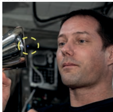
Fig. 8 : Utilisation de la pince acoustique TELEMAQUE pour piéger une bille (entourée en jaune) par Th. Pesquet lors de la mission Alpha (Juillet 2021).
