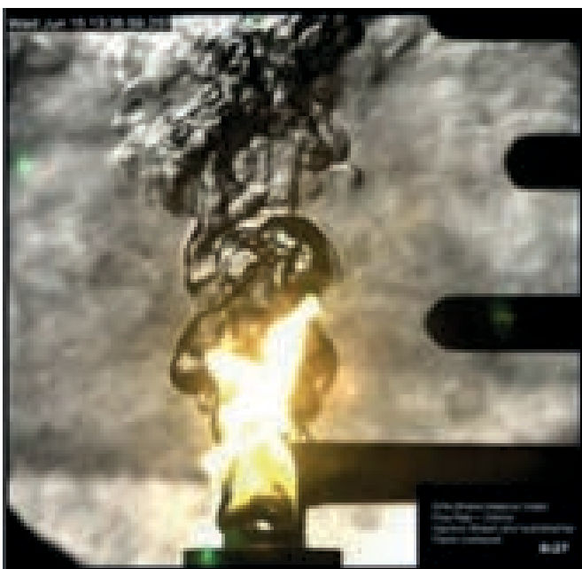
Fig.9 : première visualisation de SCWO (~220 bar) Enveloppe de flamme non-prémélangée bleue (caractéristique de la combustion des alcools)
