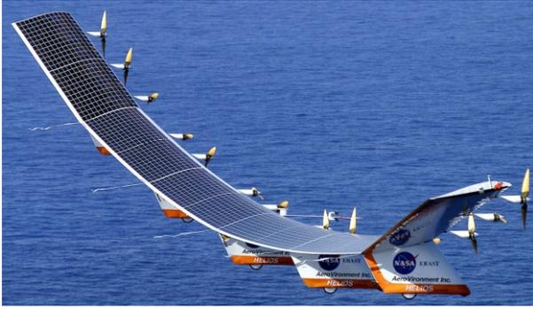
Le prototype d'avion solaire NASA Helios.
