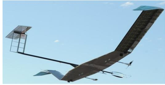
Avion Zephyr de Airbus-QinetiQ. Image
