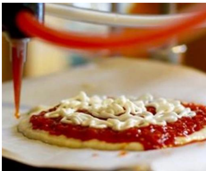
Figure n° 12 : UNE PIZZA FABRIQUÉE PAR IMPRESSION 3D À PARTIR D'ALIMENTS GÉNÉRIQUES QUI POURRAIENT ÊTRE TRANSFORMÉS SELON LE SOUHAIT DES ASTRONAUTES
