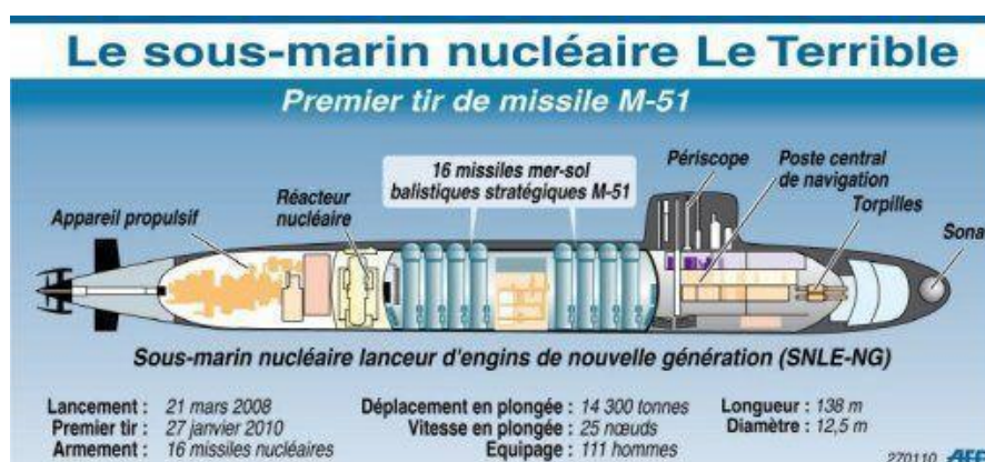
Figure n° 31 : SCHEMA D'UN SOUS-MARIN NUCLÉAIRE LANCEUR D'ENGIN FRANÇAIS
