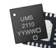
MMIC de UMS assemblé en boîtier QFN © UMS
