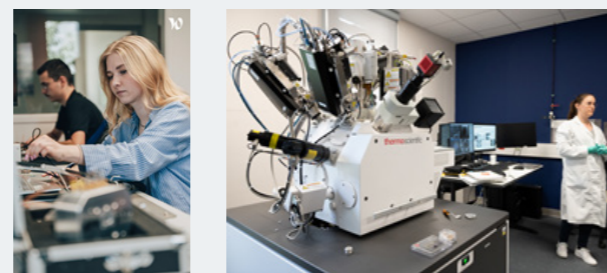
Exemple de moyen à l'état de l'art de nos laboratoires : A gauche - préparation des détecteurs de radiation (R2D2 lab), à droite - Le FIB-Edit 'Centrios'(lab LE) qui permet la réparation de circuits intégrés à des échelles inférieures au micromètre.
