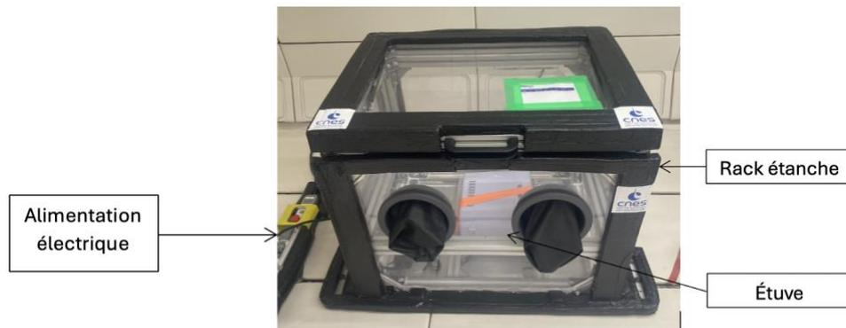
**Figure 6 : Expérience test mise en place dans l'Airbus A310 Zéro G.**
