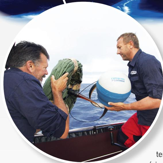
Mise à l'eau d'une bouée équipée de balise Argos et de différents capteurs d'étude de l'eau.
