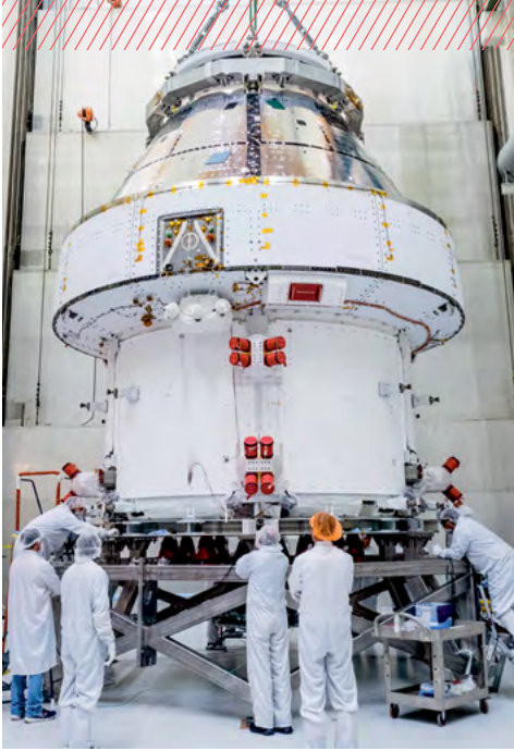
La capsule Orion et son module de service après leur intégration au Kennedy Space Center de la NASA.
