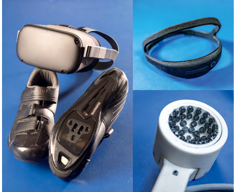
À gauche : casque de réalité virtuelle Oculus Quest et chaussures de cycliste pour l'expérience Immersive Exercise. En haut à droite : modèle de qualification du bandeau du sommeil de l'expérience Dreams. En bas à droite : modèle de laboratoire de la « pince » acoustique de l'expérience Télémaque.
