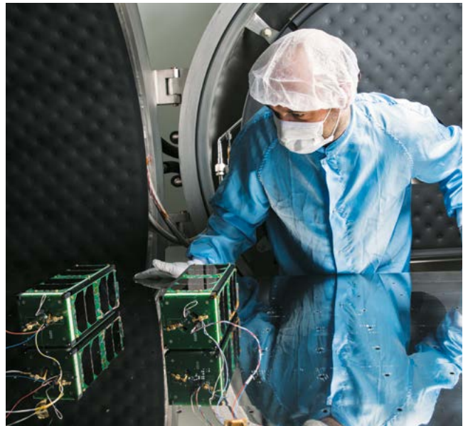
X-Cubesat de l'École polytechnique et Spacecube de l'École des mines dans la cuve thermique de la plateforme d'intégration et de tests de l'Université Versailles-Saint-Quentin-en-Yvelines.
