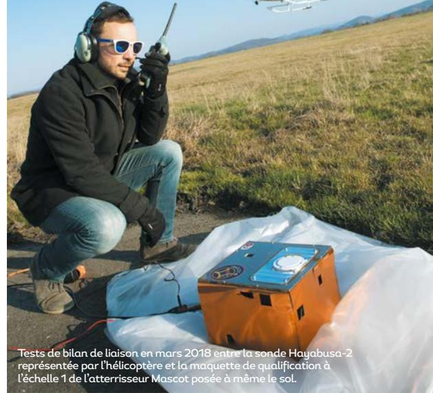
Tests de bilan de liaison en mars 2018 entre la sonde Hayabusa-2 représentée par l'hélicoptère et la maquette de qualification à l'échelle 1 de l'atterrisseur Mascot posée à même le sol.
