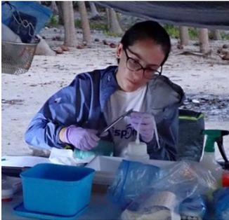
**Récupération d'ADN environnemental (ADNe)** : le filtrage d'échantillons d'eau permet de récupérer l'ADN de cellules, tissus ou excréments laissés par les êtres vivants. Des techniques de biologie moléculaire permettent d'identifier les espèces auxquelles cet ADNe appartient.
