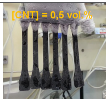
Pré-cyclage thermique d'éprouvettes composites de traction comportant des NTC. (CEA).
