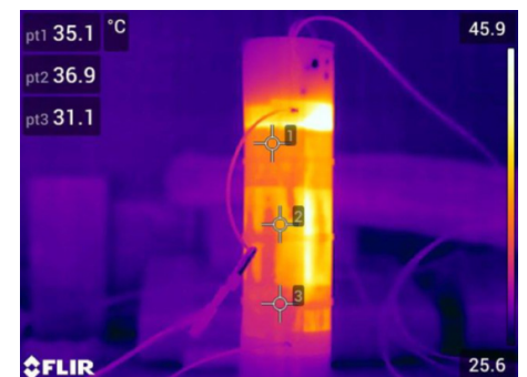
Essai sur un prototype de l'efficacité du graphène comme solution de réchauffeur de lignes d'ergols (Blackleaf).
