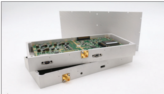
Argos-Néo, modèle miniaturisé de l'instrument Argos-4.
