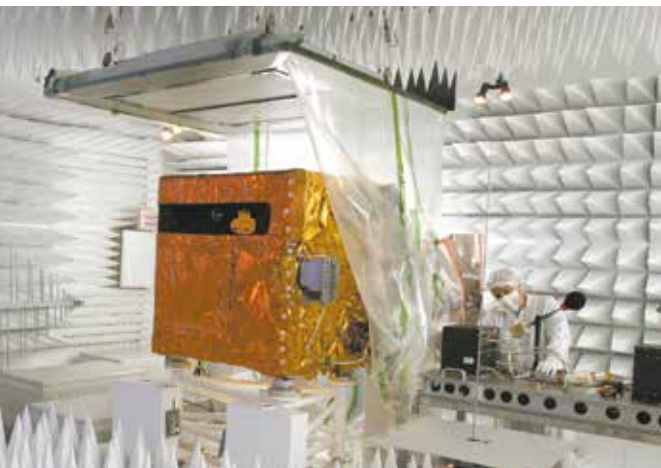
Essais de compatibilité électromagnétique de l'instrument en chambre anéchoïque.
