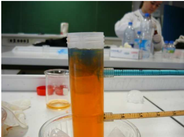
L'eau chaude, moins dense coloré en rouge se déplace et pousse l'eau froide vers le bas.
