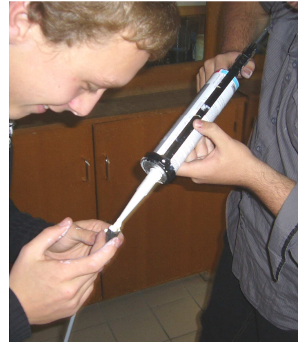
Début de l'assemblage des 2 capteurs sur un bout de tube PVC
