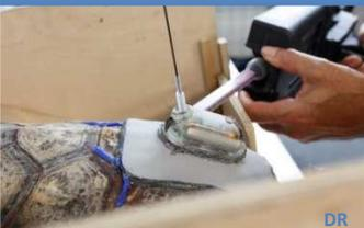
Pour équiper une tortue marine, on recouvre sa tête d'un tissu opaque humide pour protéger ses yeux du soleil et limiter son stress. La balise est fixée par une résine époxy à prise rapide sur la zone la plus haute de la carapace : la balise sortira de l'eau lors de la respiration de la tortue marine et permettra l'émission du signal vers les satellites.
