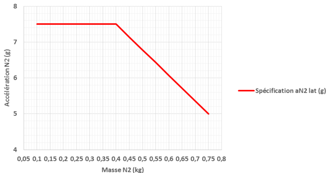
BLD NG2 - Spécification des niveaux d'accélération latéraux de la nacelle N2 en fonction de sa masse Masse nacelle N1 = [2,7kg - 3kg]
