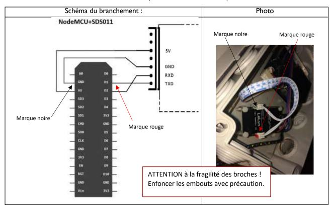
Etape 2: assemblage point mesure externe particules + T/H
