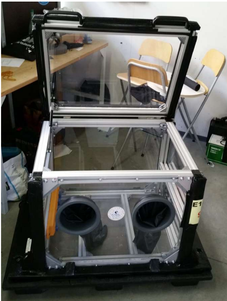
Figure 2 : Vue générale du châssis étanche
