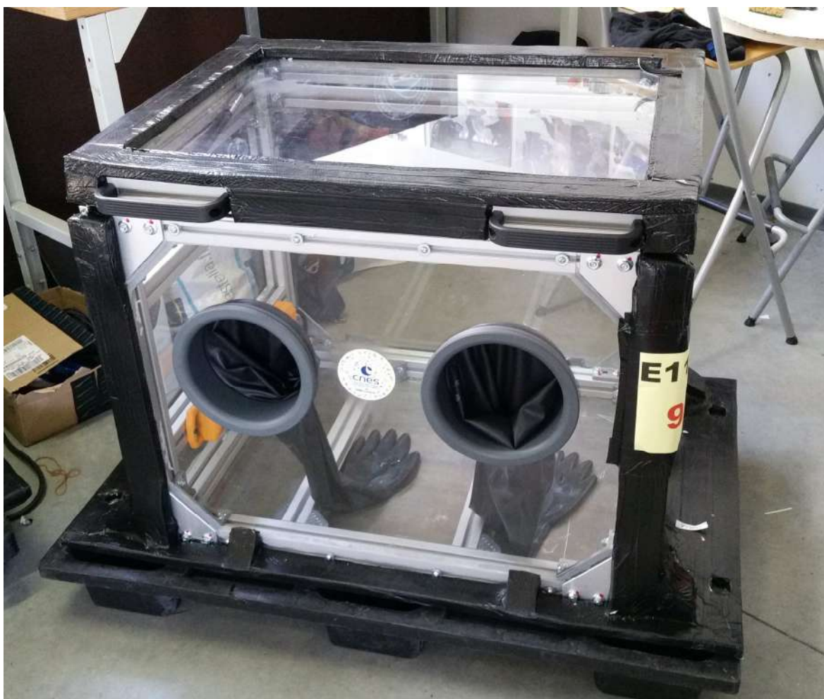
Figure 2 : Vue générale du châssis étanche montrant en particulier la paire de gants permettant d'accéder aux expériences dans le confinement du châssis
