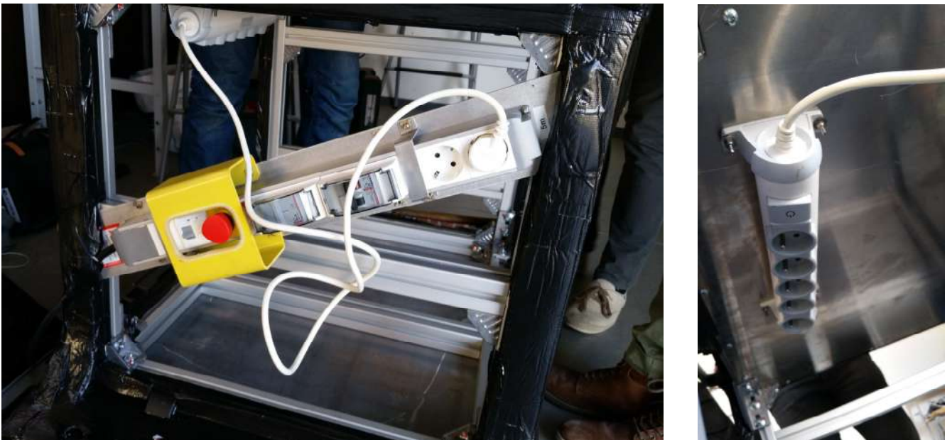
Figure 5 : Distribution électrique du châssis mécanique, la barre de distribution est fixée sur les profilés du châssis, une nourrice fixée sous la tôle abritant la partie mesure permet de brancher jusqu'à 5 prises
