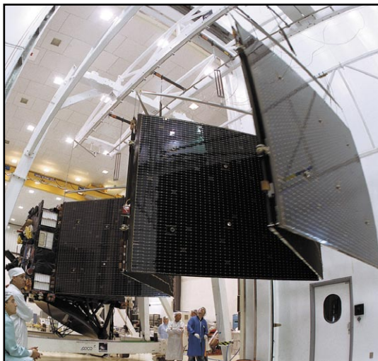
Test de déploiement des panneaux solaires de Rosetta. © ESA.
