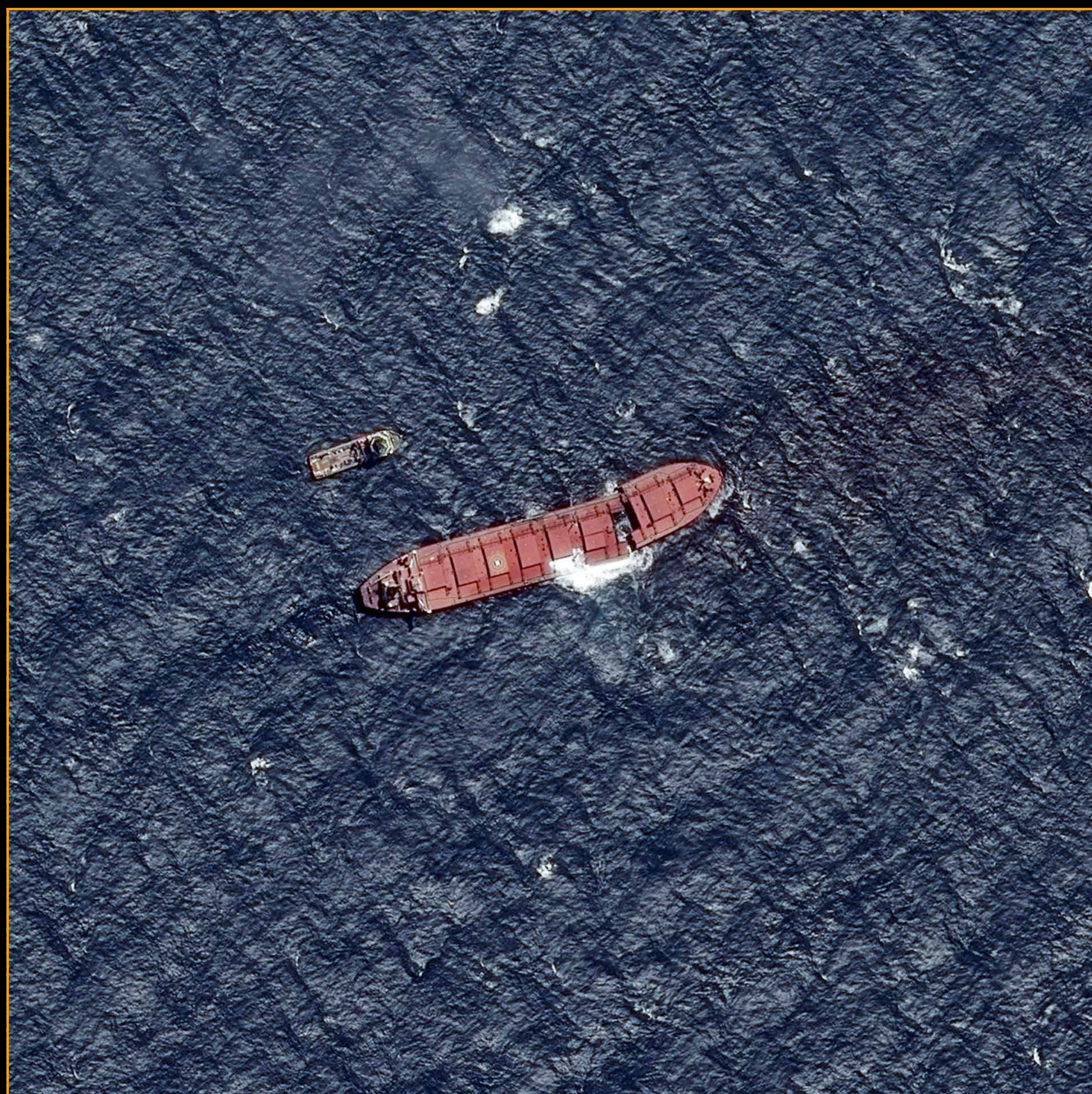
27 Mars 2016 . La fracture grandit dangereusement et les vagues envahissent le pont. Le New Mykonos finira par se briser en deux et sombrer sur place.
