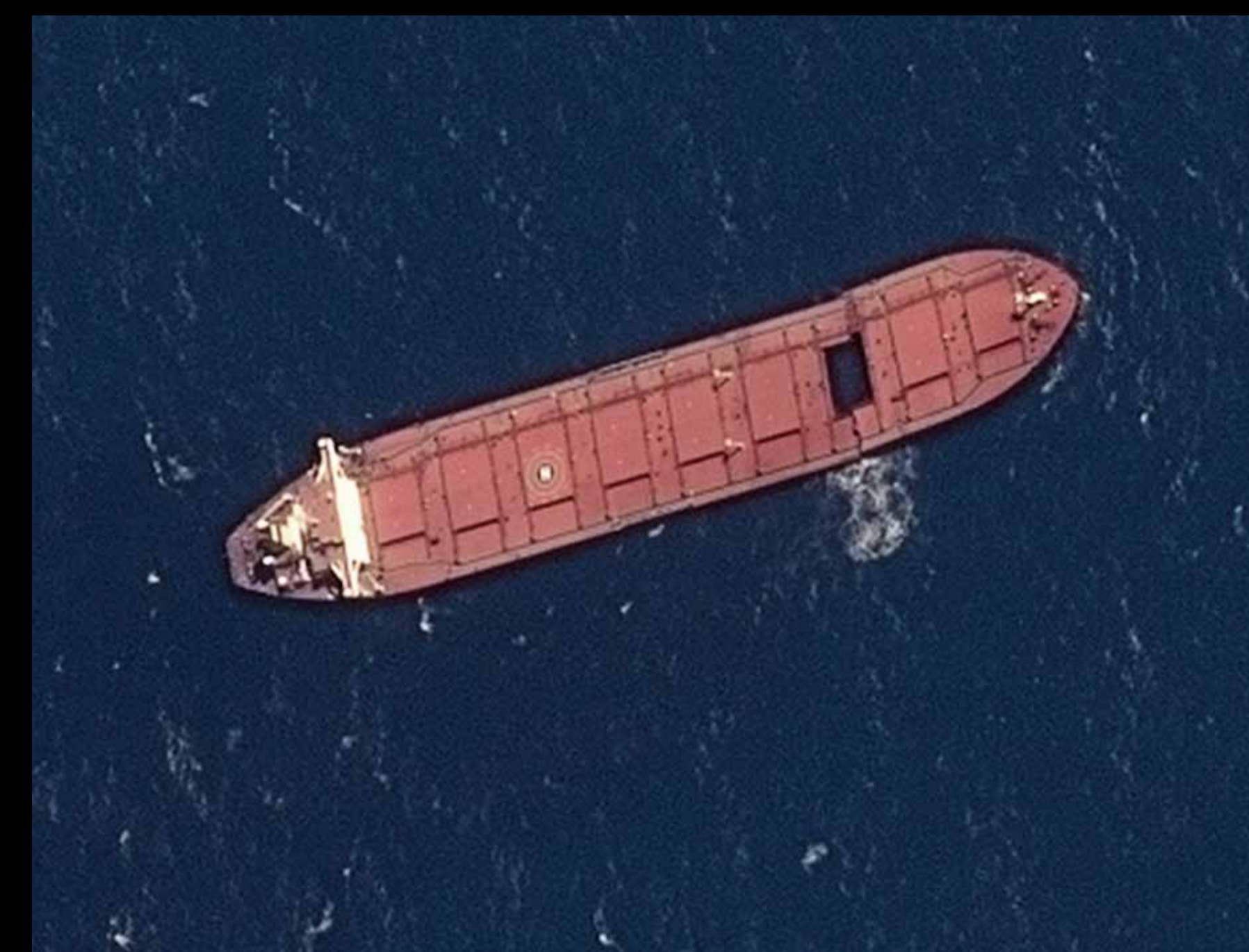
17 mars 2016 . La cassure est nette, une porte de cale a été retirée. Assurant la sécurité et prêts à intervenir, des navires restent à proximité mais le remorquage est désormais clairement compromis.
