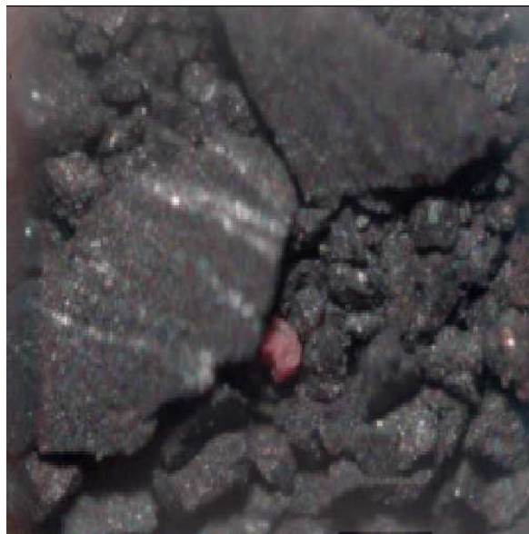
Image obtenue par MicrOmega d'échantillons de Ryugu. Le grain rouge au centre est riche en radical OH indiquant une hydratation de ce grain. © IAS/CNRS/université Paris Saclay
