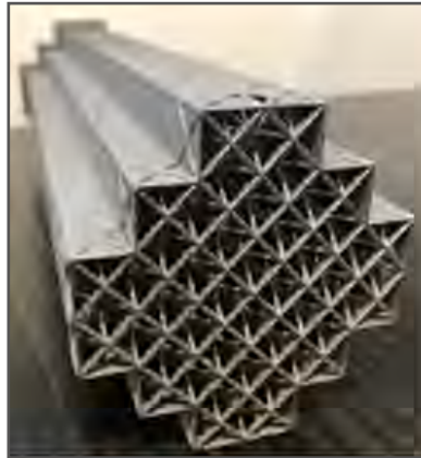
Absorbeur d'énergie en matériau architecturé pour pied d'atterrissage (Sokaris).
