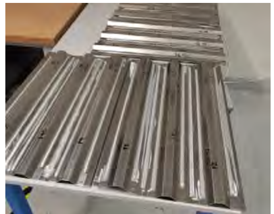
Panneau raidi par soudage FSW par transparence (Stirweld).
