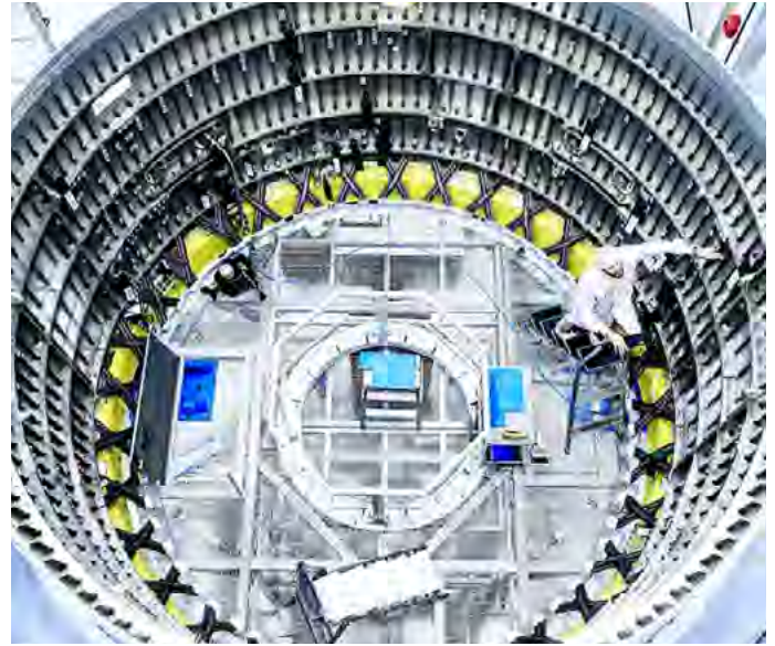
Structure inter-réservoir de l'étage inférieur d'Ariane 6 (MTA).
