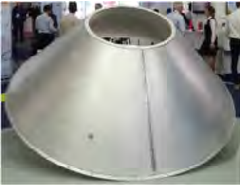
Démonstrateur d'un adaptateur de charge utile en sandwich tout aluminium (Halcyon).
