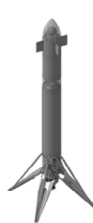
Démonstrateur de véhicule réutilisable CALLISTO permettant de monter en maturité sur la récupération.
